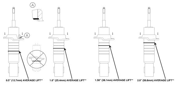
▶BOTTOM CIRCLIP GROOVE IS FOR STOCK RIDE HEIGHT ONLY
